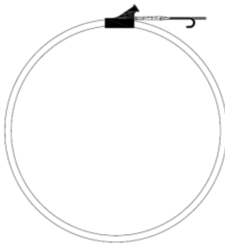
Obrázek 4: Nákres zásobníkové obruče s proplachovacím adaptérem a narovnávačem
