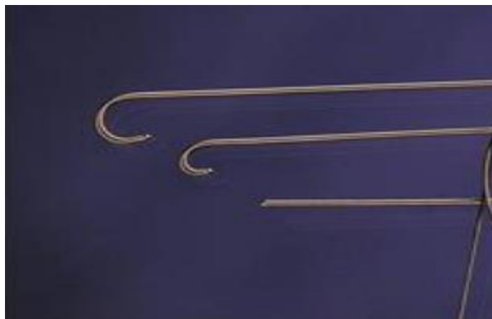
Abbildung 2: Führungsdrähte aus PTFE-beschichtetem Edelstahl
