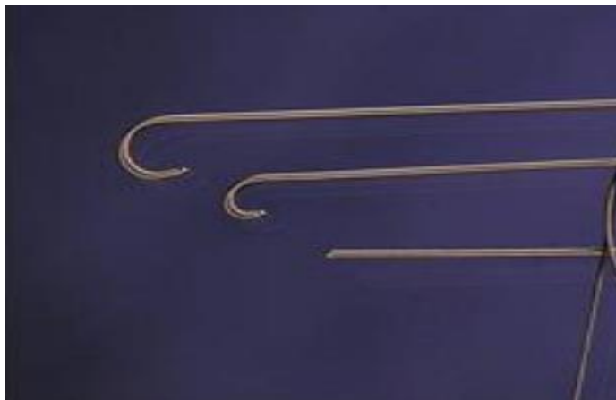
Joonis 2: PTFE-kattega roostevabast terasest juhtetraadid
