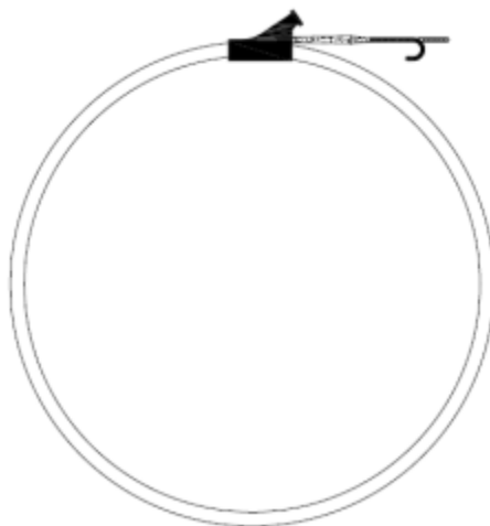
Figure 4 : Illustration de l'anneau du distributeur avec adaptateur de rinçage et redresseur
