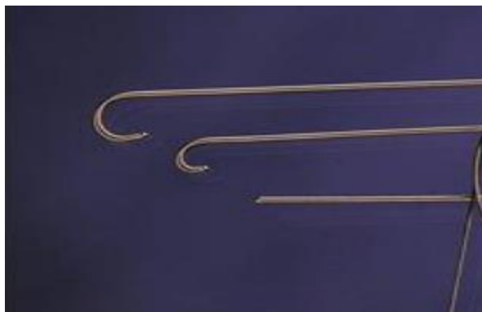
Figura 2: Fili guida di acciaio inossidabile con rivestimento in PTFE
