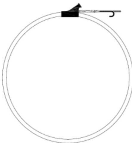
Rysunek 4: Rysunek obręczy dozownika z adapterem do przeplukiwania i prostownicą
