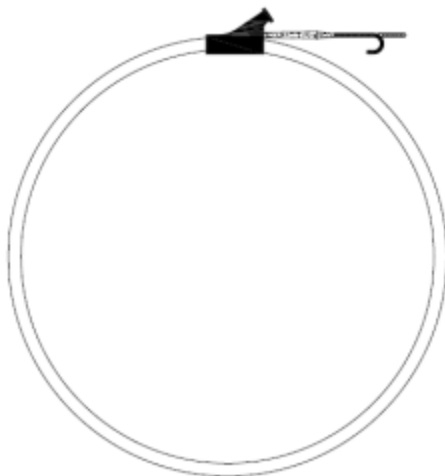
Obr. 4: Nákres zásobníka s adaptérom na vyplachovanie a s narovnávačom
